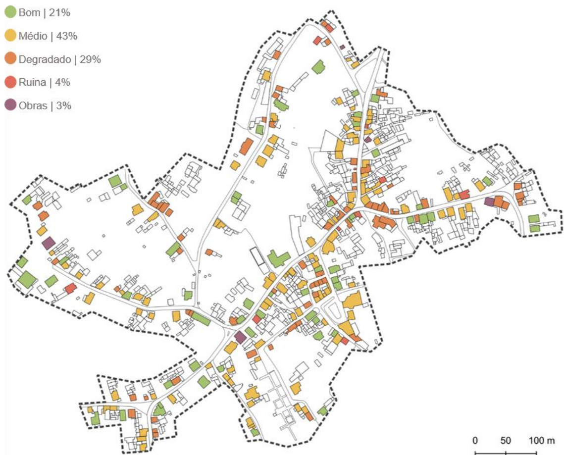
Planta 5. Estado de conservação
